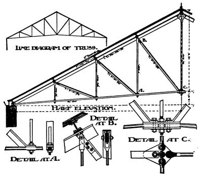
Fig. 9.—Queen-rod Roof Truss.)
